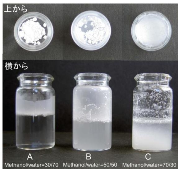
図 5 メタノール/水の混合溶液中で超音波振動を加えた状態で攪拌した C18 充填剤の分散状態
