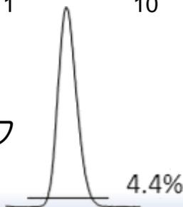
ピークの4.4%の高さの位置でのピーク幅で理論段数を計算 (5σ法)
