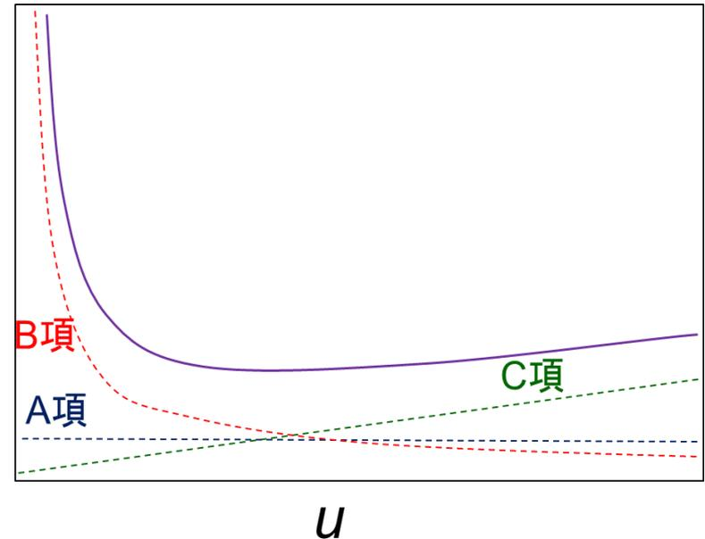
A項 : 多流路拡散、渦巻き拡散
