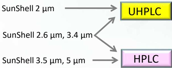
2 μmのコアシェルカラムは段数も高く、シャープなピークでピーク容積も非常に小さくなります。またカラム圧も高くなりますので、装置内部の流路容積を最小になるように設計され、なおかつ耐圧の高いUHPLCが必須になります。
