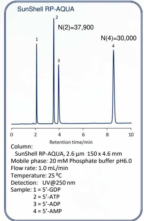
SunShell RP-AQUAはUHPLCを用いるとATPの段数は37,000段を超えます。
