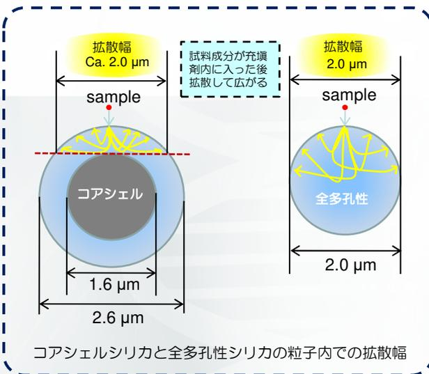
カラム内の充填剤の隙間に流れる移動相の速度と充填剤の細孔内に流れる移動相速度は1000倍から10000倍の差があり、細孔内では移動相は実質流れていないと言えます。つまり、溶質は充填剤細孔内に入り込むとブラウン運動により拡散し細孔内を移動します。ブラウン運動による移動ですので、全ての方向に均一に広がると考えられます。したがって、2 μmの全多孔性充填剤は最大粒子径の2 μmの幅まで広がることとなります。左図に示されている様にコアシェル充填剤はコア(核)が存在するため、溶質の充填剤細孔内での広がりは2 μmの全多孔性充填剤とほぼ同じである様に見えます。例えば90%の確率での溶質の広がりは、2.6 μmのコアシェル充填剤と2 μmの全多孔性充填剤はほぼ同じであると考えられます。
