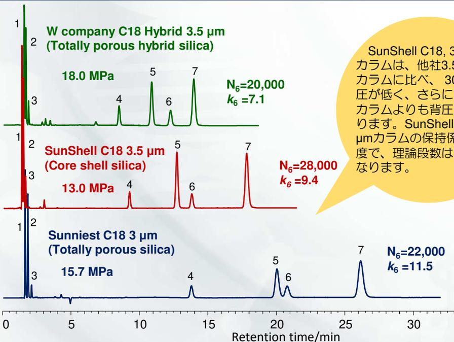
SunShell C18, 3.5 μm カラムは、他社3.5 μmのカラムに比べ、30%近く背圧が低く、さらに弊社3 μmカラムよりも背圧は低くなります。SunShell C18, 3.5 μmカラムの保持係数は中程度で、理論段数は最も高くなります。
