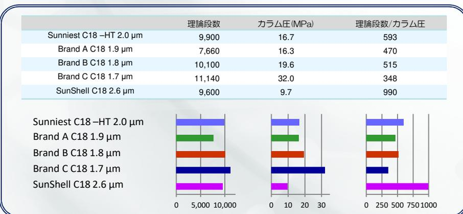
サブ2 μm C18カラムおよび2 μmのSunniest C18-HTとSunShell C18、2.6 μmの理論段数とカラム圧を比較しました。理論段数は1.9 μm C18を除きほぼ同じでしたが、カラム圧は大きく異なりました。特に1.7 μm C18は高いカラム圧を示しました。SunShell C18はカラム圧が低いため、一定圧力下での理論段数の割合で比較した場合、SunShell C18はその値は非常に大きくなります。つまり、SunShell C18はある一定(例えば30 MPa)の圧力条件下では最も高い性能を有しております。
