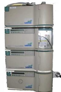
HPLCでもフローセルの容量を小さくし、配管の内径を細くしたセミマイクロ仕様にてできれば、UHPLCに近い性能が出ます。さらに検出器の応答速度を0.05秒にすることにより、特にピーク幅の狭いピークほど理論段数はあがります。ピーク幅が2秒以上のピークはセミマイクロ仕様HPLCでもコアシェルカラムの性能を100%近く発揮させることができます。
