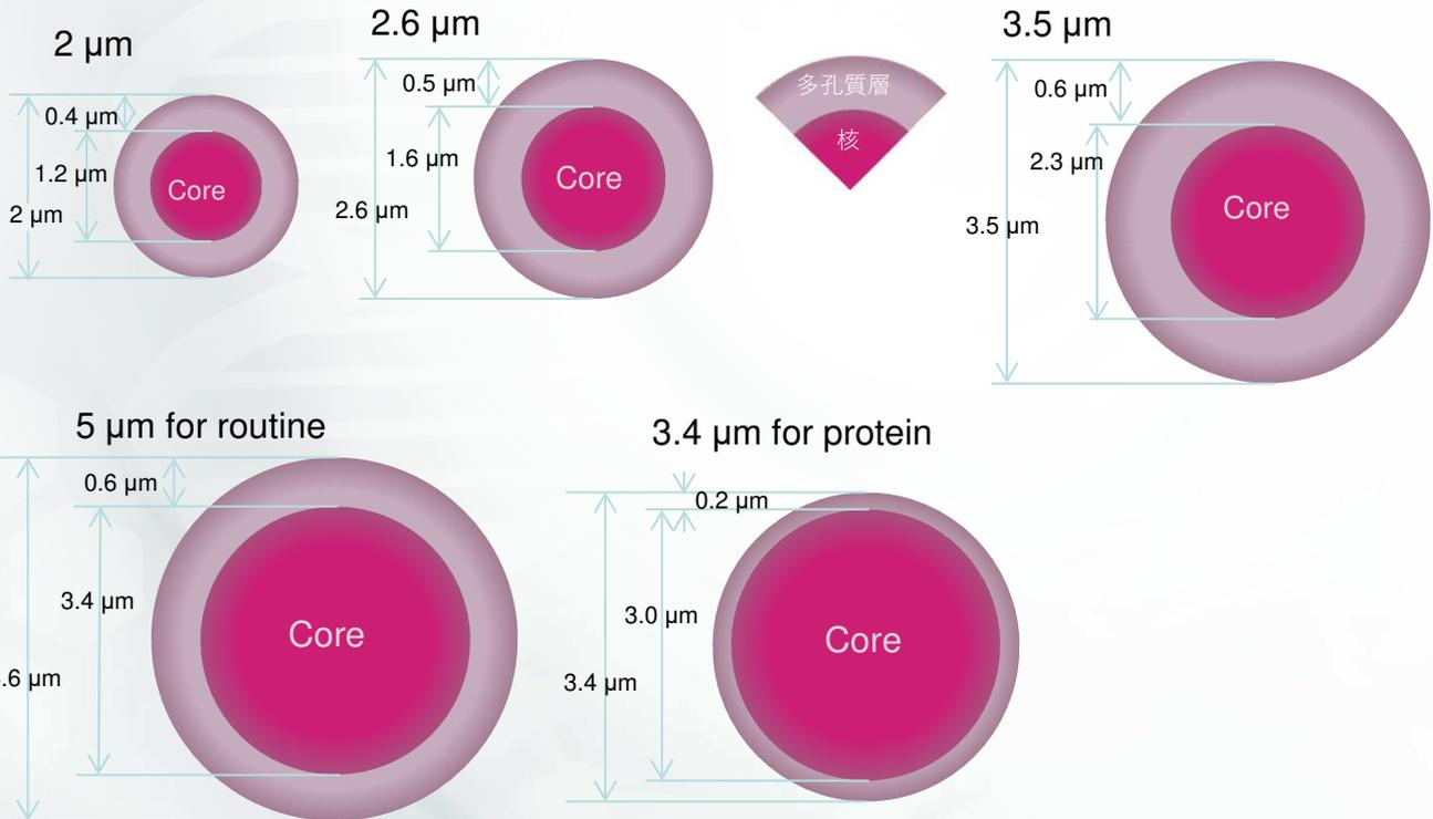
2  $\mu\text{m}$ , 2.6  $\mu\text{m}$ , 3.4  $\mu\text{m}$ , 3.5  $\mu\text{m}$ と5  $\mu\text{m}$ コアシェルシリカの概略図
