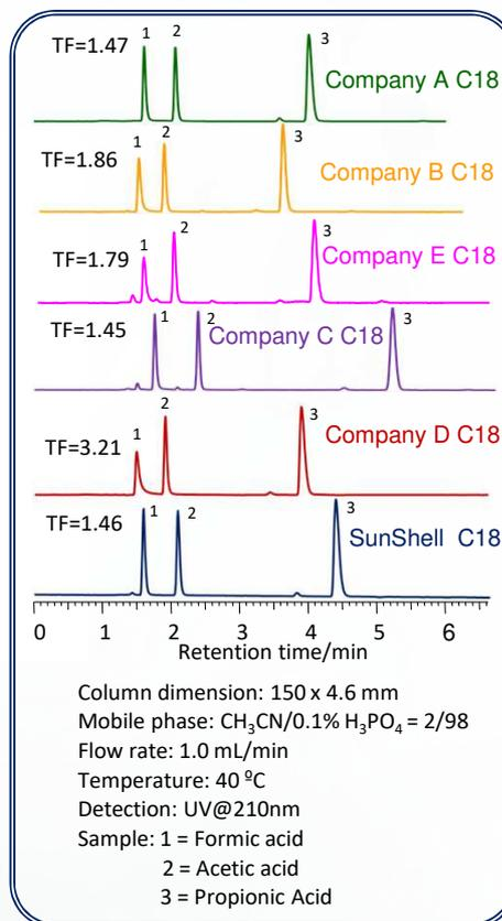
ピリジンは残存シラノール基によりテーリングが起こりやすい化合物です。新品のカラムでこの試験を最初に行っていますが、ピーク形状がおかしいA社C18は、新品でも固定相表面に酸が残っている可能性があります。
