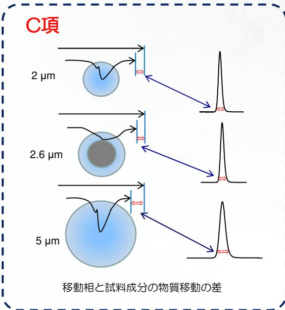
左図に示される様にコアシェル(SunShell)粒子は内部に核が存在しており、表面の多孔質層が薄いため、試料成分が粒子内に入り込み、再び出てくるときの拡散距離が短くなります。つまり粒子内での拡散による物質移動距離または物質移動時間が2.6 μmのコアシェル充填剤とサブ2 μmの全多孔性充填剤はほぼ等しくなります。
