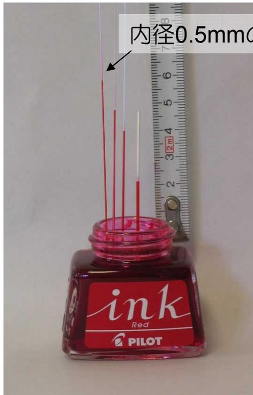
内径0.5mmのガラス管内で赤インクは6cm上昇する。6cm上昇時に作用してる圧力は0.006気圧である。内径が $1\mu\text{m}$ では30m上昇し、3気圧の圧力が作用していることになる。
