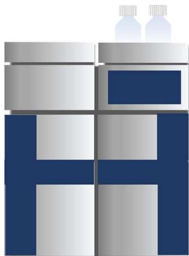
HPLC装置 耐圧：20 MPa～40 MPa
