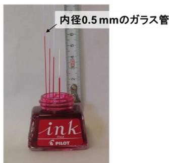
内径0.5 mmのガラス管内で赤インクは6 cm上昇する。この場合に作用している圧力は0.006 気圧である。内径が1  $\mu\text{m}$ では30 m上昇し、3気圧の圧力が作用していることになる。
