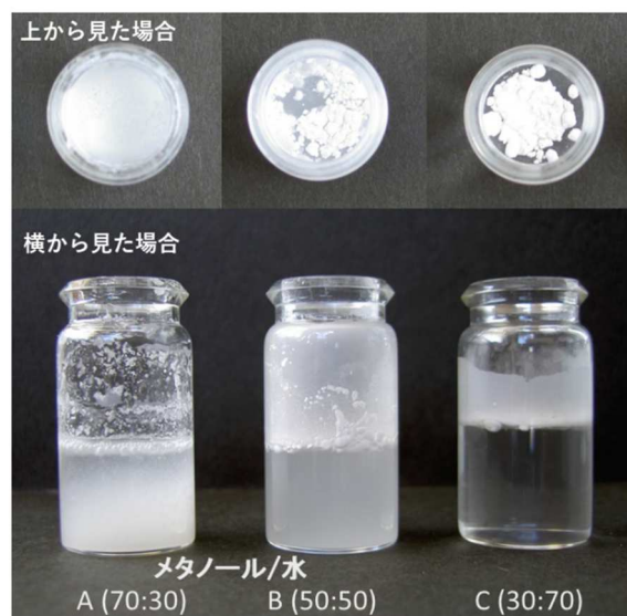
図 7 メタノール/水の混合溶液中で超音波振動を加えた状態で攪拌した C18 充填剤の分散状態 Packing material, 5 \mu m dp C18, 10-nm pore size; solution, A = methanol/water = 70/30, B = methanol/water=50/50, C = methanol/water=30/70.
