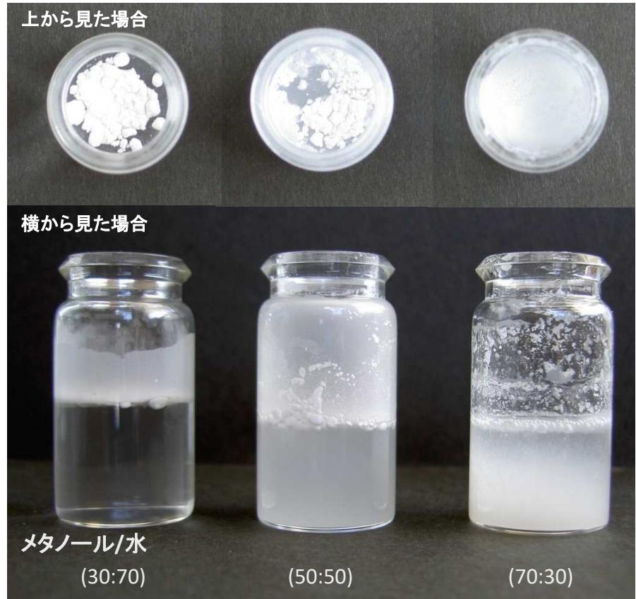
それぞれの溶液にC18充填剤を混ぜ、超音波の振動を加えながら攪拌混合した。
