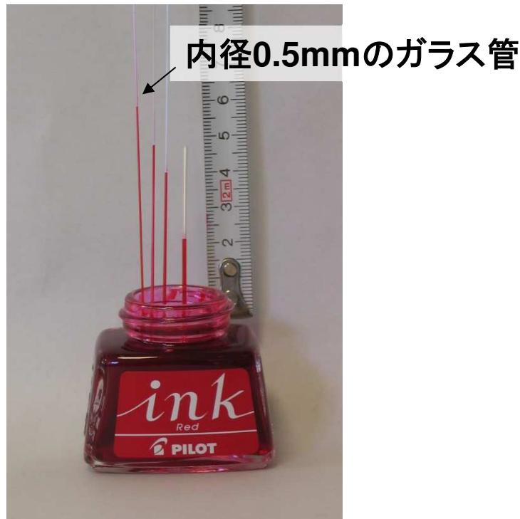
内径0.5mmのガラス管内で赤インクは6cm上昇する。この場合に作用して圧力は0.006気圧である。内径が $1\mu\text{m}$ では30m上昇し、3気圧の圧力が作用していることになる。
